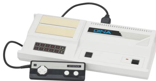
**Figura 7.** Dina 2 in 1, console clone compatível com o SG-1000 e o Colecovision.
